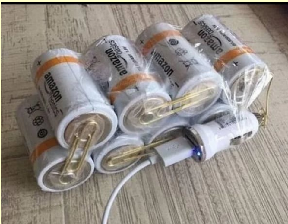
Alimentation de dépannage
