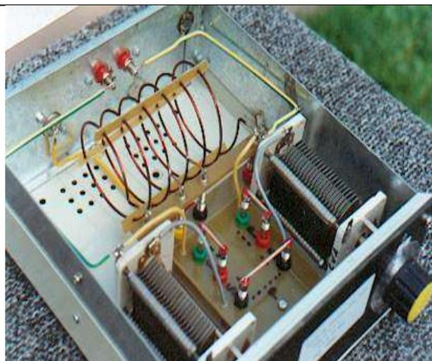
Grâce à ses 5 selfs interchangeables ce coupleur permet un accord facile sur les 8 bandes décamétriques d'une antenne alimentée par ligne bifilaire. L'antenne peut être branchée sur les bornes PP' comme sur le schéma ci-dessous (accord parallèle) ou sur les bornes SS' après avoir enlevé le cavalier (accord série). D'après F6BPO c'est le meilleur des coupleurs pour antenne Lévy.
