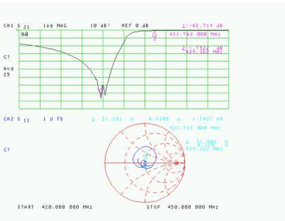
Fig. 62 : Double affichage sur l'écran pour les mesures  $S_{21}$  et  $S_{11}$  du filtre TX du duplexeur.
