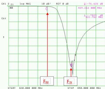
Fig. 53 : Les trois cavités du filtre RX sont à présent accordées sur la fréquence TX. La perte d'insertion commence à devenir acceptable (-0,78 dB) à la fréquence RX et l'atténuation de l'effet éliminateur de bande est à présent de -76,6 dB à la fréquence TX. On peut observer sur cette figure qu'il n'y a plus de résidu parasite dans la courbe de réponse au niveau de la bande passante du filtre RX à la fréquence RX.
