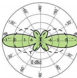
Fig. 1 : Diagramme de rayonnement dans le plan d'élévation d'une antenne verticale omnidirectionnelle d'un gain de 5 dB<sub>s</sub> (3 dB<sub>d</sub>). Source : Procom, Base Station and Marine Antenna, type CXL 70/3LW/1 (380-470 MHz). Sur ce diagramme, les traits discontinus représentent le diagramme d'un dipôle vertical d'un gain de 0 dB<sub>s</sub> pour comparaison. On observera sur cette figure les deux « nuls » principaux de l'antenne situés précisément sur l'axe vertical de l'antenne.
