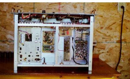
Fig. 12 : Rack électronique d'un répéteur où l'on peut observer le blindage de l'émetteur et celui du récepteur. On observe attentivement les nombreux condensateurs de traversée regroupés par blindages distinctifs et situés sur une paroi intermédiaire placée en arrière de la face avant du rack. Source : Repeater N1BUG, Stickney Hill, Brownville, Comté de Piscataquis, état du Maine aux USA.
