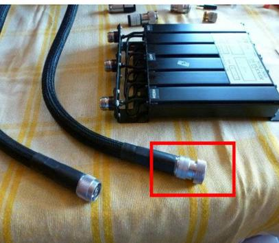
Fig. 28: Raccordement d'un calibre de court-circuit à l'extrémité du câble raccordé au 2<sup>ème</sup> port de mesure de l'analyseur de réseau vectoriel.
