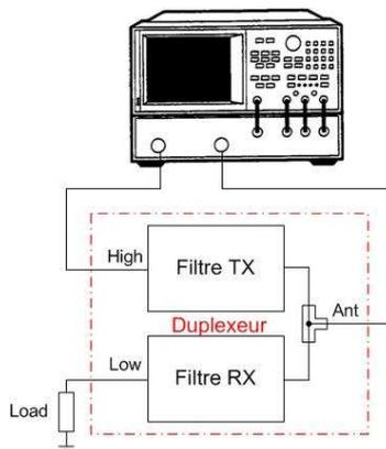
Fig. 20: 1<sup>ère</sup> étape qui consiste à mesurer le coefficient de transmission du filtre TX du duplexeur tout en plaçant une charge à l'entrée du filtre RX. Remarque : peu importe le sens de raccordement des ports de mesure ; en effet, la mesure du coefficient de transmission peut être effectuée dans les deux sens, c'est-à-dire le S21 ou le S12 à l'analyseur de réseau vectoriel.
