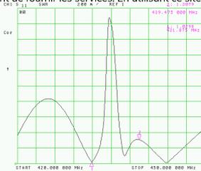
Fig. 43 : Mesure du coefficient de réflexion au port « Ant » du duplexeur ONOLG qui est affiché en valeur de SWR. Le ROS est de 1,03 : 1 à 431,875 MHz et est de 1,31 : 1 à 439,475 MHz.
