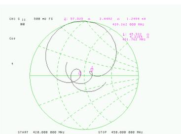
Fig. 55 : Lieu géométrique de l'impédance complexe présente au port « Antenne » du duplexeur en fonction de la
