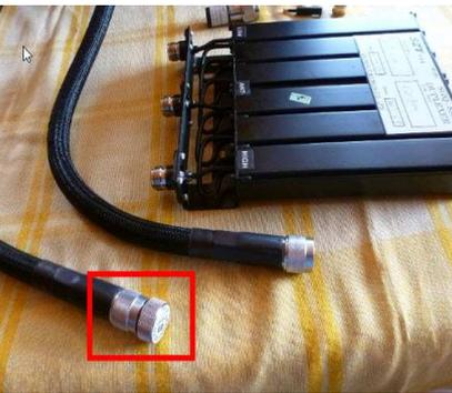
Fig. 25: Raccordement d'un calibre de court-circuit à l'extrémité du câble raccordé au 1<sup>er</sup> port de mesure de l'analyseur de réseau vectoriel.
