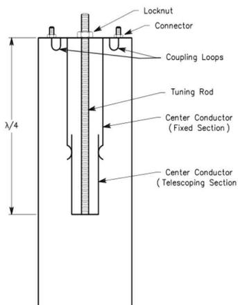
Fig. 17 : Illustration du principe mécanique du réglage de l'accord en fréquence d'une cavité (ici passe-bande) par allongement ou raccourcissement physique de la longueur du résonateur quart d'onde. Source : ARRL Antenna Book, 21<sup>ème</sup> édition, seconde édition, chapitre 17, page 17-10, Repeater Antenna Systems, (à la figure 18 du
