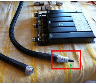
Fig. 27: Raccordement d'un calibre de circuit ouvert à l'extrémité du câble raccordé au 2<sup>ème</sup> port de mesure de l'analyseur de réseau vectoriel.
