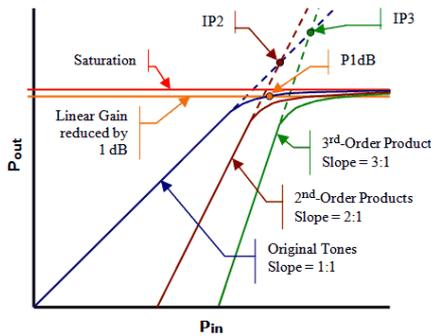
Fig. 5 : Point de compression 1 dB. Source : rfcafe.com.
