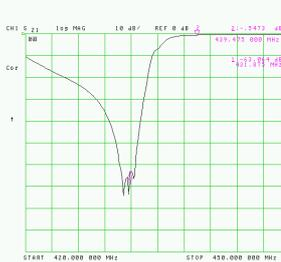
Fig. 39: Mesure du coefficient de transmission  $S_{21}$  du filtre TX entre le connecteur « Ant » et « High » du duplexeur. La perte d'insertion est de 0,5 dB à 439,475 MHz et l'atténuation est de -63,1 dB à 431,875 MHz
