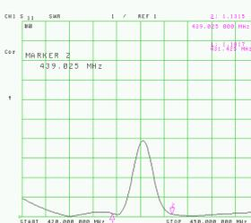
Fig. 34: Mesure du coefficient de réflexion sur le port « Ant » du duplexeur et affichée sous le format SWR à l'analyseur de réseau vectoriel.
