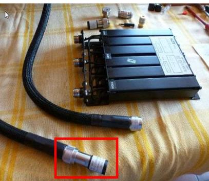
Fig. 26: Raccordement d'une charge fictive étalon à l'extrémité du câble raccordé au 1<sup>er</sup> port de mesure de l'analyseur de réseau vectoriel.
