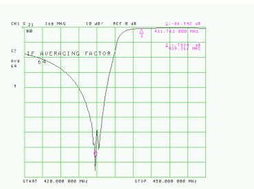
Fig. 60 : Idem figure précédente mais pour le filtre TX réglé de manière optimale. La perte d'insertion est de -0,79 dB et l'atténuation de la fréquence RX rejetée est de -86,9 dB.
