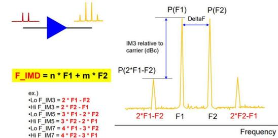
Fig. 3 : Origine de l'intermodulation due aux non linéarités d'un amplificateur. Source Agilent Technologies : IMD Measurement with E5072A ENA Series Network Analyzer, June 2012.
