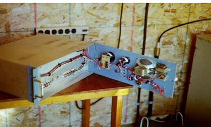
Fig. 14 : Rack électronique d'un répéteur où l'on peut observer la paroi de blindage située en arrière de la face avant équipée de galvanomètres de mesure, d'éléments de signalisation, connecteurs, interrupteurs et haut-parleur de monitoring. C'est sur cette figure qu'on peut observer le mieux les nombreux condensateurs de traversée. Source : Repeater N1BUG, Stickney Hill, Brownville, Comté de Piscataquis, état du Maine aux USA.
