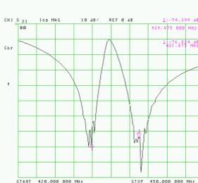
Fig. 41: Mesure du coefficient de transmission  $S_{21}$  des deux cavités en cascade où l'on observe l'effet éliminateur de bande des deux filtres.
