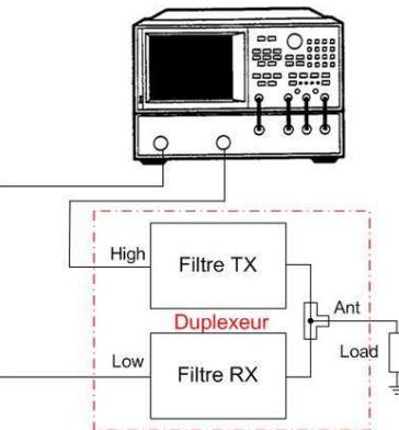
Fig. 22: 3<sup>ème</sup> étape de mesure qui consiste à mesurer le coefficient de transmission de l'ensemble des deux filtres du duplexeur placés en cascade tout en plaçant une charge à la sortie « Antenne » du duplexeur. Même remarque que la figure 20 pour le sens de raccordement des ports de mesure.
