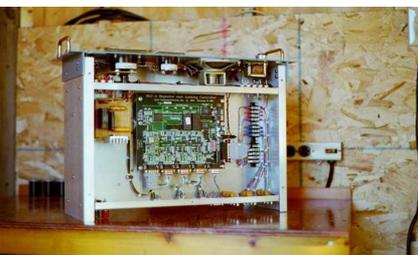
Fig. 13 : Rack électronique d'un répéteur où l'on peut observer le blindage de la logique de commande et du bornier de distribution des lignes d'alimentation. On observera ici aussi les nombreux condensateurs de traversée situés sur une paroi intermédiaire placée en arrière de la face avant du rack. Source : Repeater N1BUG, Stickney Hill, Brownville, Comté de Piscataquis, état du Maine aux USA.
