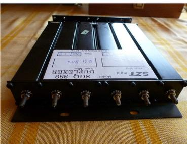
Fig. 16 : Duplexeur UHF à 6 cavités du répéteur ONORCA. Vue sur les tiges filetées permettant le réglage d'accord en fréquence.
