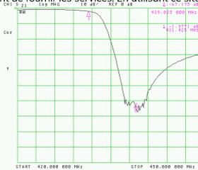
Fig. 32: Mesure du coefficient de transmission  $S_{21}$  du filtre RX entre le connecteur « Ant » et « Low » du duplexeur. Une charge est placée sur le connecteur « High ».
