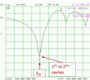
Fig. 48 : La 2<sup>ème</sup> cavité du filtre TX est à présent accordée sur la fréquence RX et son effet éliminateur de bande vient se superposer à celui de la 1<sup>ère</sup> cavité.
