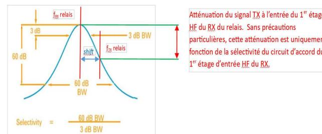
Fig. 2 : Expression de la sélectivité d'un filtre passe-bande. Source Agilent. Commentaire sur la relativement faible atténuation du signal d'émission du relais à l'entrée du récepteur de celui-ci en fonction de la sélectivité relativement faible du circuit résonnant du 1<sup>er</sup> étage d'entrée de ce récepteur.
