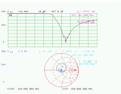
Fig. 61 : Double affichage sur l'écran pour les mesures  $S_{21}$  et  $S_{11}$  du filtre RX du duplexeur.
