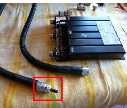
Fig. 24: Raccordement d'un calibre de circuit ouvert à l'extrémité du câble raccordé au 1<sup>er</sup> port de mesure de
