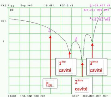
Fig. 46 : Cavités désaccordées du filtre TX. L'effet éliminateur de bande est bien loin de se situer sur la fréquence RX. On constate trois minima dans la courbe qui correspondent aux fréquences sur lesquelles les trois cavités se situent actuellement.
