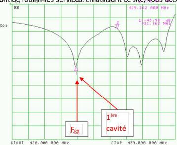
Fig. 47 : La 1<sup>ère</sup> cavité du filtre TX est à présent réglée sur la fréquence RX. On devrait trouver sur la courbe uniquement deux autres minima correspondant aux deux autres cavités du filtre. Sur la figure ci-dessus on observe un minimum excédentaire qui provient d'une rétroaction parasite des cavités du filtre RX. Lorsque le filtre RX sera réglé à son tour, son influence deviendra négligeable sur le filtre TX comme nous pourrons le constater par la suite.
