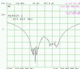
Fig. 33: Mesure du coefficient de transmission  $S_{21}$  des filtres TX et RX en cascade entre le connecteur « Low » et « High » du duplexeur. Une charge est placée sur le connecteur « Ant ».
