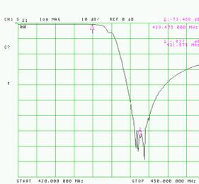
Fig. 40: Mesure du coefficient de transmission  $S_{21}$  du filtre RX entre le connecteur « Ant » et « Low » du duplexeur. La perte d'insertion est de 0,8 dB à 431,875 MHz et l'atténuation est de -73,5 dB à 439,475 MHz.
