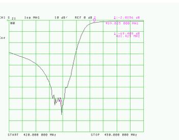
Fig. 31: Mesure du coefficient de transmission  $S_{21}$  du filtre TX entre le connecteur « Ant » et « High » du duplexeur.
