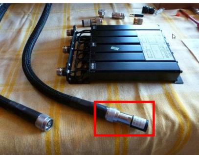
Fig. 29: Raccordement d'une charge fictive étalon à l'extrémité du câble raccordé au 2<sup>ème</sup> port de mesure de l'analyseur de réseau vectoriel.
