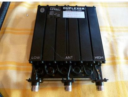
Fig. 45 : Duplexeur servant de « pièce martyre » pour vous montrer, pas à pas, la procédure de réglage.
