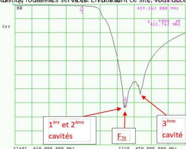
Fig. 52 : La 1<sup>ère</sup> et 2<sup>ème</sup> cavités sont accordées sur la fréquence TX.
