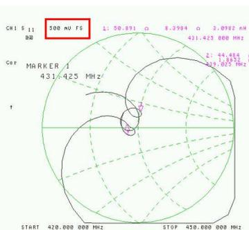
Fig. 37: Idem figure 35 mais avec un facteur d'échelle d'affichage de 0,5 unité à fond d'échelle de l'abaque de Smith, ce qui permet de mieux visualiser la position des deux marqueurs proches du centre de l'abaque.
