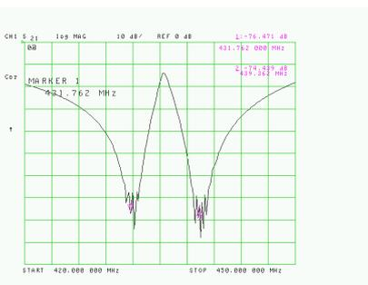
Fig. 63 : Courbe de mesure du coefficient de transmission des deux filtres RX et TX du duplexeur. Sur cette figure, la fonction du calcul de moyenne sur un nombre d'échantillons n'a pas été activée. Pour réaliser des mesures stables aux fortes atténuations, il est conseillé d'activer cette fonction.
