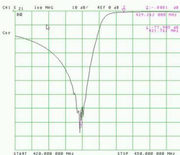
Fig. 54 : Courbe de réponse du coefficient de transmission du filtre TX du duplexeur. L'allure de la courbe est parfaite – le résidu parasite a bel et bien disparu – ; les performances de perte d'insertion (-0,8 dB) et d'atténuation (-77,9 dB) sont bonnes et correspondent aux valeurs attendues pour ce type de duplexeur.
