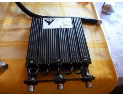
Fig. 38: Duplexeur UHF à 6 cavités du type éliminateur de bande équipant le répéteur ONOLG.
