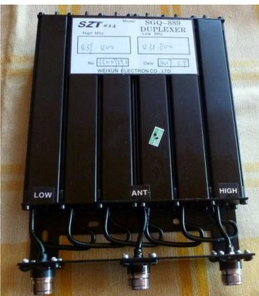
Fig. 15 : Duplexeur UHF à 6 cavités du type éliminateur de bande équipant le répéteur ONORCA.
