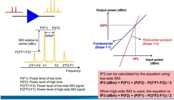
Fig. 4 : IP3, point d'interception triple d'un amplificateur. Source Agilent Technologies : IMD Measurement with E5072A ENA Series Network Analyzer, June 2012.
