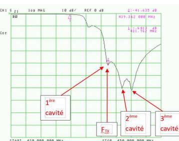
Fig. 51 : La 1<sup>ère</sup> cavité du filtre RX est à présent réglée sur la fréquence TX.
