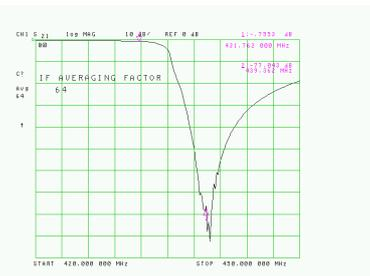
Fig. 59 : Mesure du coefficient de transmission du filtre RX réglé de manière optimale. La perte d'insertion est de -0,75 dB et l'atténuation de la fréquence TX rejetée est de -77 dB. L'analyseur est paramétré pour le calcul et l'affichage d'une valeur moyenne prise sur 64 échantillons.
