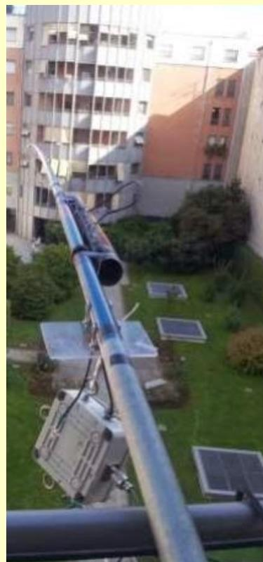
Antenne verticale HF 20,30,40m de réalisation facile, ne nécessite pas de tuner et est utilisable comme un balcon et / ou seuil.
