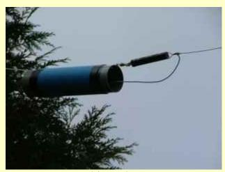
De la soustraction 42,5 - 18, il s'agissait d'enrouler 24,5 mètres sur un mandrin, en l'occurrence une section de tube PCV de 80 mm à portée de main, pour obtenir l'élément rayonnant voulu.
