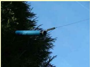
Un tube en PVC d'un diamètre de 60 mm reçut un maximum de spires en fil isolé, soit environ 39 mètres, dont une extrémité fut brasée au point le plus haut, ce qui procura 57 mètres de fil au total. Le résultat, meilleur, n'était cependant pas à la hauteur de mon exigence.
