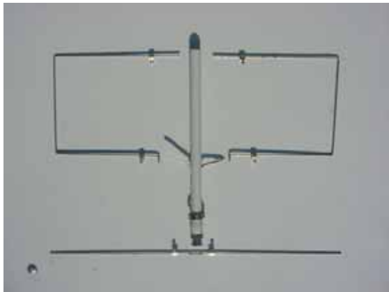
Foto 3: Conector BNC en su posición definitiva
